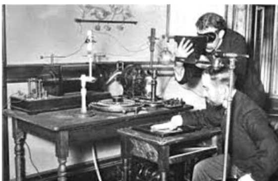
Figura 1 - Equipamento de Raios X totalmente sem blindagem
